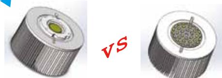
工艺流程：无需焊接，直接贴装      工艺流程：SMD 焊接，再进行贴装
